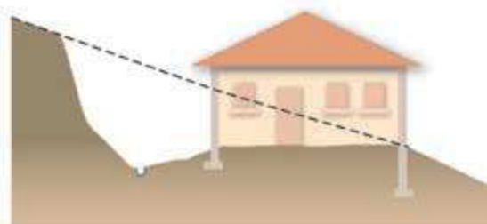
Plate-forme en déblais
